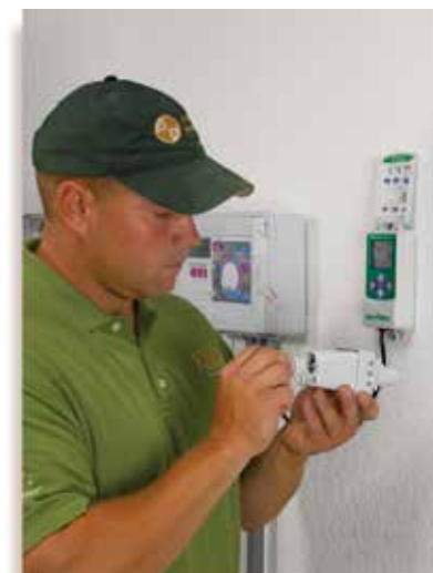
No se necesitan herramientas, ni es necesario desmontar el sensor para cambiar la batería
