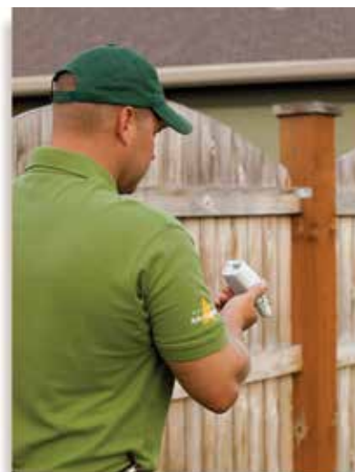
Determine la mejor localización del sensor utilizando el indicador de potencia de señal.
